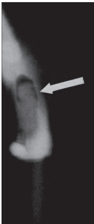
Fig. 258 Radiografia dell'elemento di giuntura ad arco del tripode B.3 in corrispondenza di un innesto della verghetta. – (Da Lechtman/Steinberg 1970, 7 fig. 4, dettaglio).
