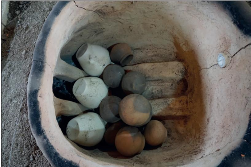
**Abb. 5** Die unterste Lage der eingesetzten Kugeltöpfe vor dem Feuergitter wiesen den größten Grad an Versinterung auf. Die weißen »Platzhalter« (s. Anm. 18) wurden als Schutz vor dem Prallfeuer vor das Feuergitter gesetzt. Ähnliche Sicherungsstrategien beim Besatz sind auch für vormoderne Zeiten vorauszusetzen. – (Foto M. Herdick, RGZM).
