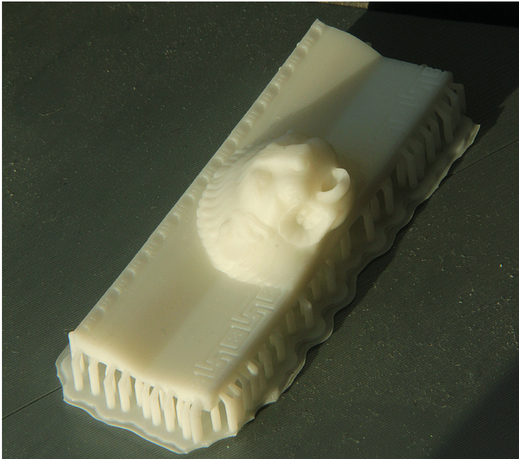
→ Teildruck der Sima mit Löwenkopfwasserspeier: Unter dem Bauglied sind die für den Druck notwendigen Hilfsstrukturen zu erkennen
