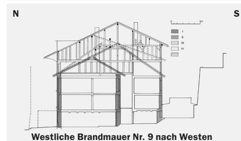
223 Thun, Obere Hauptgasse 9 und 11, Schnitte mit Bauphasen, Zeichnung von Eliane Schranz, ADB, 1999.
