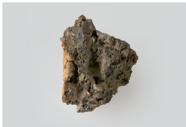
Abb. 134 Marmorera, Burganlage Marmels. Schmiedeschlacke in Kalottenform. M. 1:2.
