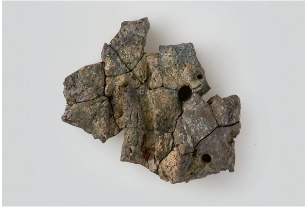
Abb. 135 Marmorera, Burganlage Marmels. Fliessschlacke der Kupfererzverhüttung aus der Schlackendeponie 14 und der stark holzkohle- und aschehaltigen Schicht 16, zusammengesetzt aus 12 Bruchstücken. L. 8,7 cm, B. 9,6 cm, D. 2,7 cm, Dichte 3,7, Gewicht 240 g, mit schwacher Magnetisierung. M. 1:2.
