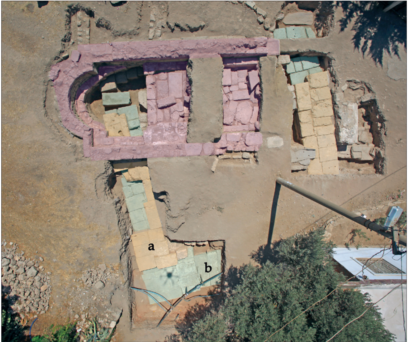
Abb. 13 Luftaufnahme der Hagios-Georgios-Kapelle mit dem antiken Fundament (orange: obere Fundamentlage a, grün: untere Fundamentlage b, rosa: Kapelle). – (Foto Didyma-Grabung/E. Küçük, Bearbeitung: I. Kaiser).
