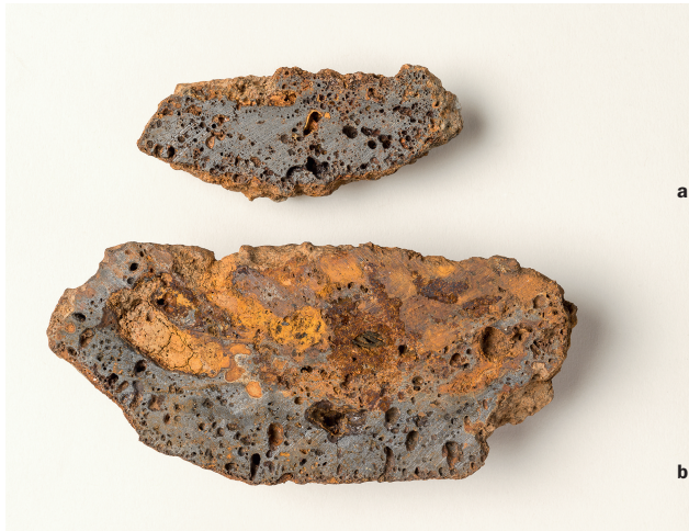
Abb. 116 Altreu SO. Eine grau-dichte Schlacke (a) sowie eine eisenhaltig-rostige Schlacke (b) im Schnitt. M. 1:2.
