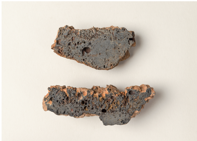
Abb. 117 Altreu SO. Geschnittene Fliessschlacken. M. 1:2.
