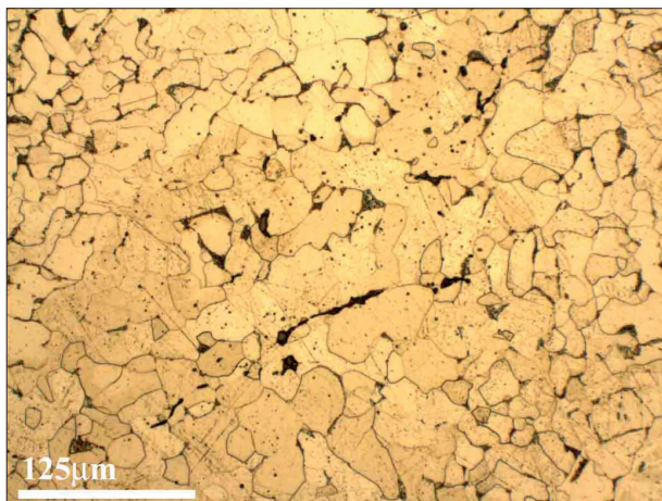
Fig. 8 Immagini ottiche della sezione del chiodo dopo attacco metallografico (Nital 2 %).
