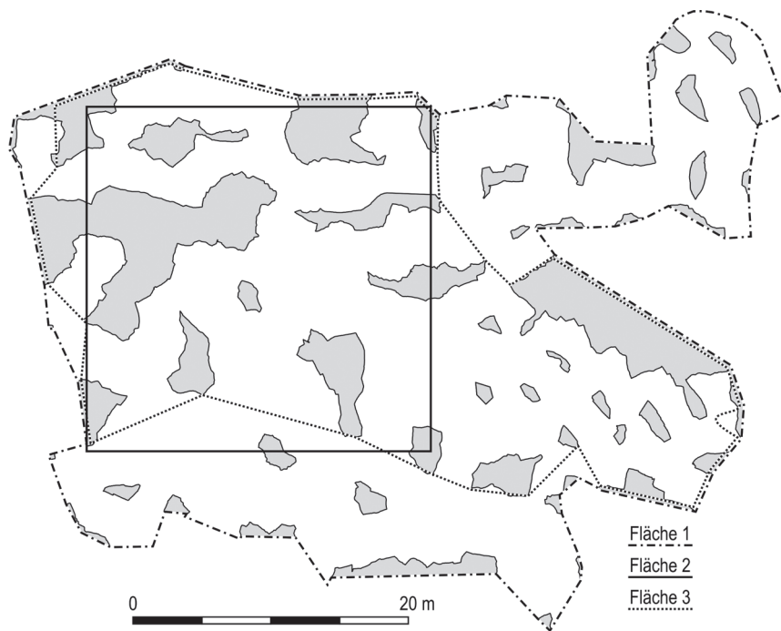
Abb. 189 FS 31, Meurin 2. Grundriss mit den Flächen 1-3. Anhand dieser Flächen wurde das Verhältnis Pfeiler zu Abbaufläche berechnet. – (Graphik B. Streubel, RGZM).
