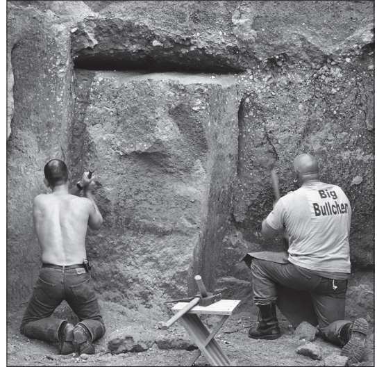
Abb. 150 FS 33, Meurin 5. Blocklösung 2: Das Einarbeiten des Seitenschrotes und der Keiltaschen. – (Foto RGZM).
