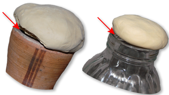
Abb. 4. Nach rechts geneigte Gefäße mit trockenen Tonverschlüssen. Dadurch, dass die Verschlüsse im trockenen Zustand kleiner sind als bei der Anbringung, rutschen sie zur Seite und es bilden sich Lücken zwischen Verschluss und Gefäßwand. Fotos: Carolin Jauf.
