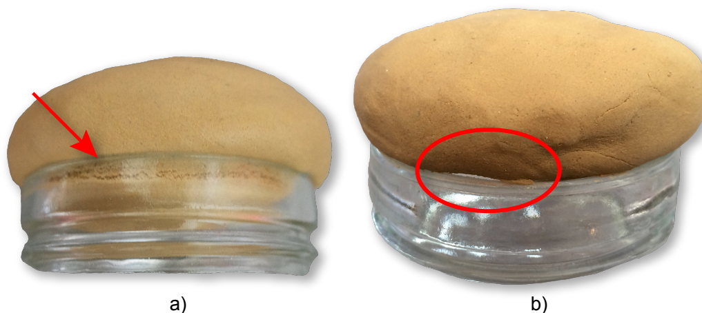
Abb. 3. a) Verschluss zieht sich während des Trocknungsvorgangs zusammen. b) Es hat sich eine Lücke zwischen Verschluss und Gefäßrand gebildet. Fotos: Carolin Jauß.
