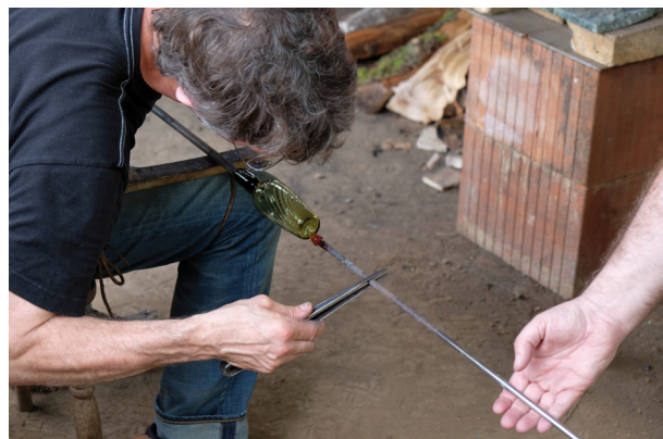
Abb. 38: Glasofenprojekt Borg, Umsetzen auf das Heftisen (Foto: D. Kreisler).
