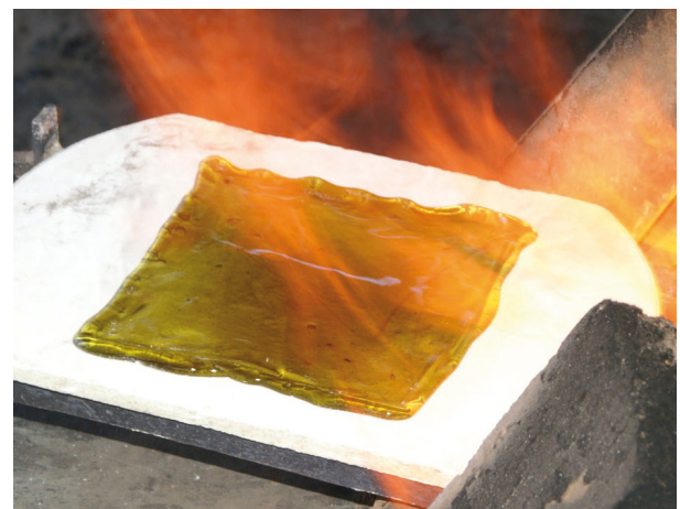
Abb. 4: Nachheizen des Werkstücks im Glasofen (Foto: M. Arz).
