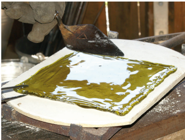
Abb. 5: Formkorrekturen am nunmehr annähernd quadratischen Werkstück. (Foto: M. Arz).
