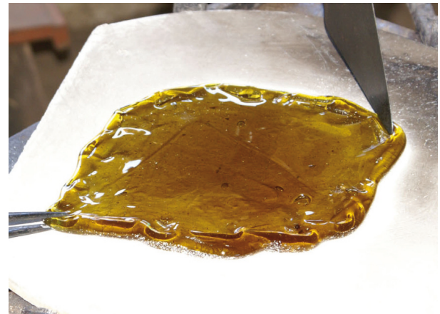
Abb. 3: Strecken des Glasfladens (Foto: M. Arz).
