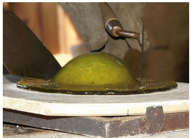
Abb. 10: Formkorrekturen im Übergang zwischen dem geraden Rand und der Kuppel (Foto: M. Arz).
