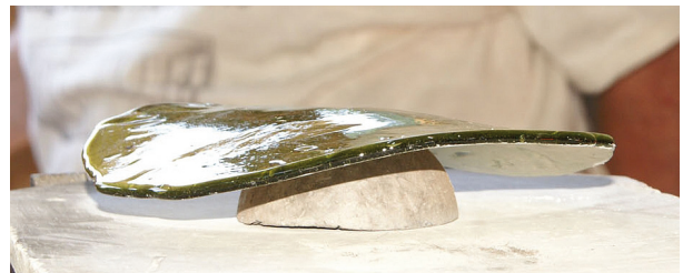
Abb. 9: Absenken des Glasfladens über die Form (Foto: M. Arz).
