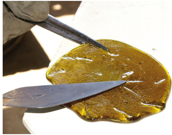
Abb. 2: Abflachen des Glaspostens zu einem Fladen (Foto: M. Arz).
