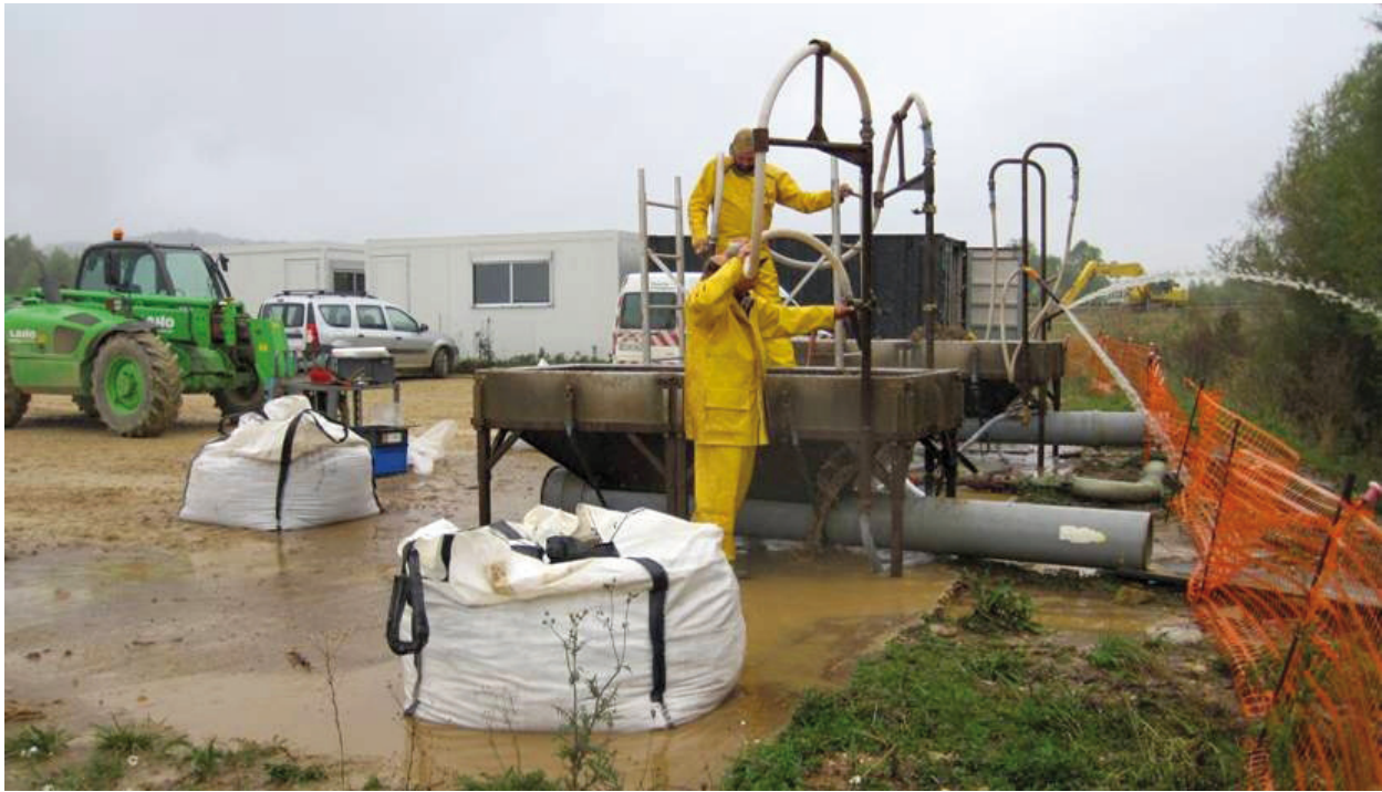
Abb. 12: Die Siebanlage, die in einer Kiesgrube bei Pont-à-Mousson installiert ist, ermöglicht es, die Verfüllung verschiedener Gruben und anderer Befunde vollständig nass zu sieben und archäologisches Fundmaterial umfassend und weitgehend vollständig zu bergen, insbesondere Kleinfunde wie Silexartefakte oder Perlen (Foto: Inrap Grand Est nord).
