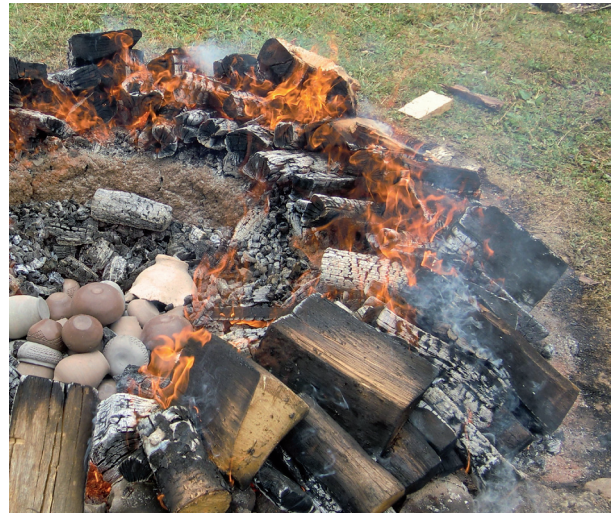
Abb. 14: Der Feldbrand. Die Keramik wird auf freiem Feld, im offenen Feuer, gehärtet. Ein Brand dauert ca. sechs Stunden und kann oxidierend oder reduzierend gebrannt werden. So wird die Keramik entweder schwarzfleckig oder durchgehend schwarz (Foto: B. Kocak).
