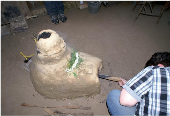
Abb. 13: Perlenofen PO-Borg 2 nach dem Trockenbrennen. Der konische Reduziererring musste abgenommen werden, um die zum Perlendrehen erforderlichen Temperaturen zu erreichen. (Foto M. Arz).
