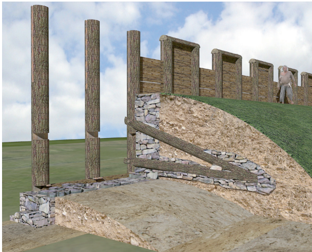
Abb. 5: Donnersberg. Modellrekonstruktion der rückwärtigen Queranker der Frontpfosten in den Pfostenschlitzmauern (3D-Computerrekonstruktion: R. Seidel).
