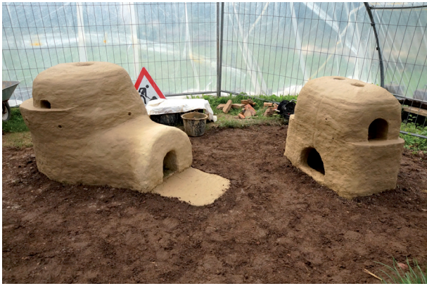
Abb. 1: Glas-Schmelzöfen und Kühlöfen in der Villa Borg vor Start des Borg Furnace Projects 2013 [Foto: F. Wiesenberg].
