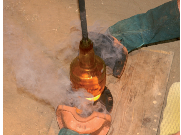
Abb. 12: Entnehmen eines Zirkusbecher-Rohlings aus der Form [Foto: M. Arz].
