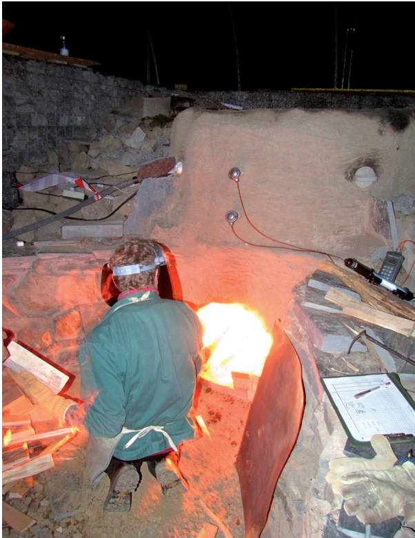
Abb. 3: Experimenteller Brand der Rekonstruktion eines spätantiken Ofens der Mayener Töpferindustrie. Untersuchungen hoch- und spätmittelalterlicher Ofentypen sollen folgen. Das Langzeitprojekt wird in Kooperation mit den Fachschulen für Keramikgestaltung und Keramiktechnik in Höhr-Grenzhausen durchgeführt [Foto: RGZM, E. Hanning].
