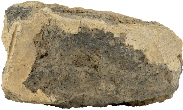
Abb. 35 Mendig, »Lungenkärchen«. Basaltstein mit Mörtel und Fugenstrich. – (Foto B. Streubel, RGZM). – M. 1:3.
