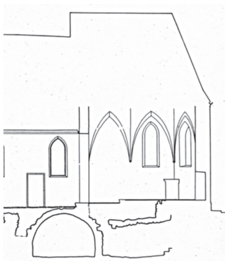
Abb. 43 Längsschnitt durch die Kirche mit Lage der tonnengewölbten, Nord-süd ausgerichteten Krypta (quer zum Kirchenschiff in der Länge der Chorbreite der Periode IV) und dem von Osten kommenden zweiphasigen Stollen
