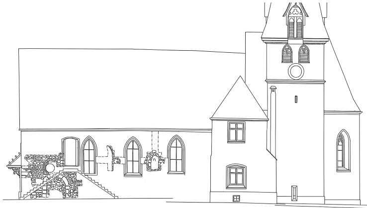
Abb. 15 Schematische Darstellung der südlichen Kirchaußenfassade von 1985 mit Teilfreilegung des Mauerwerks
