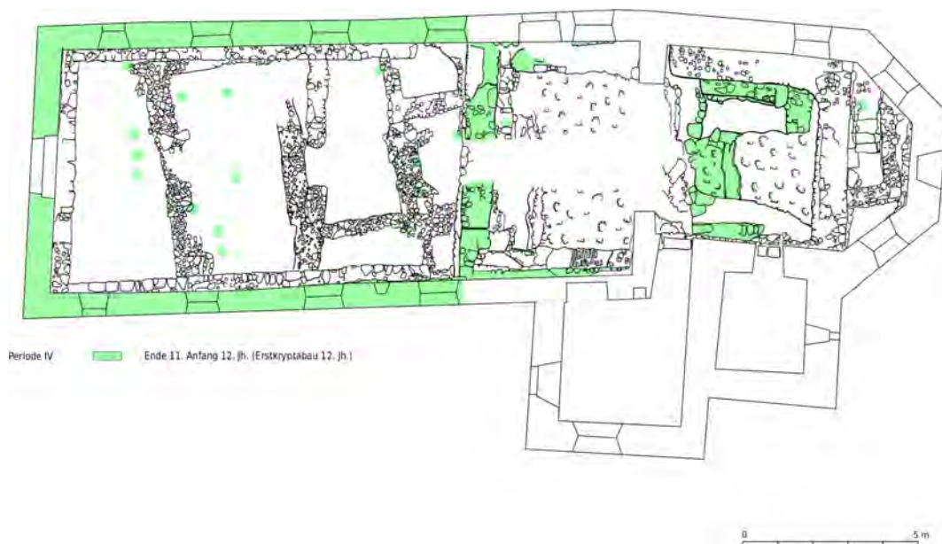
Abb. 42 Fundamentstrukturen des Kirchengebäudes der Periode mit zugehörigen Grüstpfeilergruben
