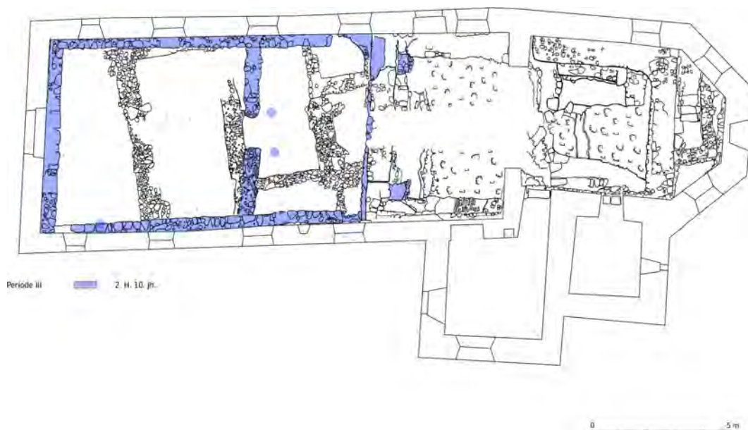
Abb. 36 Nachgewiesene Fundamentstrukturen der ersten Steinkirche mit zugehörigen Gerüstpfostengruben
