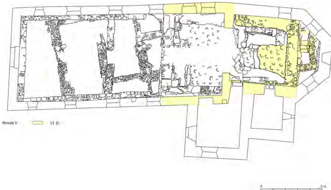
Abb. 53 Erweiterung des Kirchenschiffs nach Osten, neuer Rechteckchor und Änderungen (Verlängerung) am Stollen der Krypta nach Osten mit abknickendem Treppenaufgang nach außen in Richtung Kirchenvorplatz.
