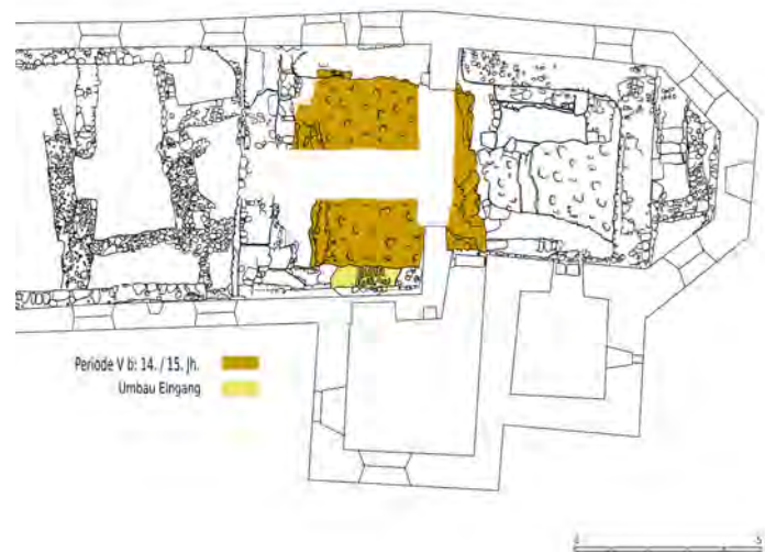
Abb. 62 Lage der tonnengewölbten Krypta im heutigen Grundriß quer zum Kirchenschiff mit Änderung am Südzugang
