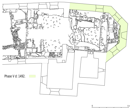
Abb. 69 Grundriß des Polygonalchors unter Nutzung der nördlichen Turmwand/vormalige Chorsüdwand
