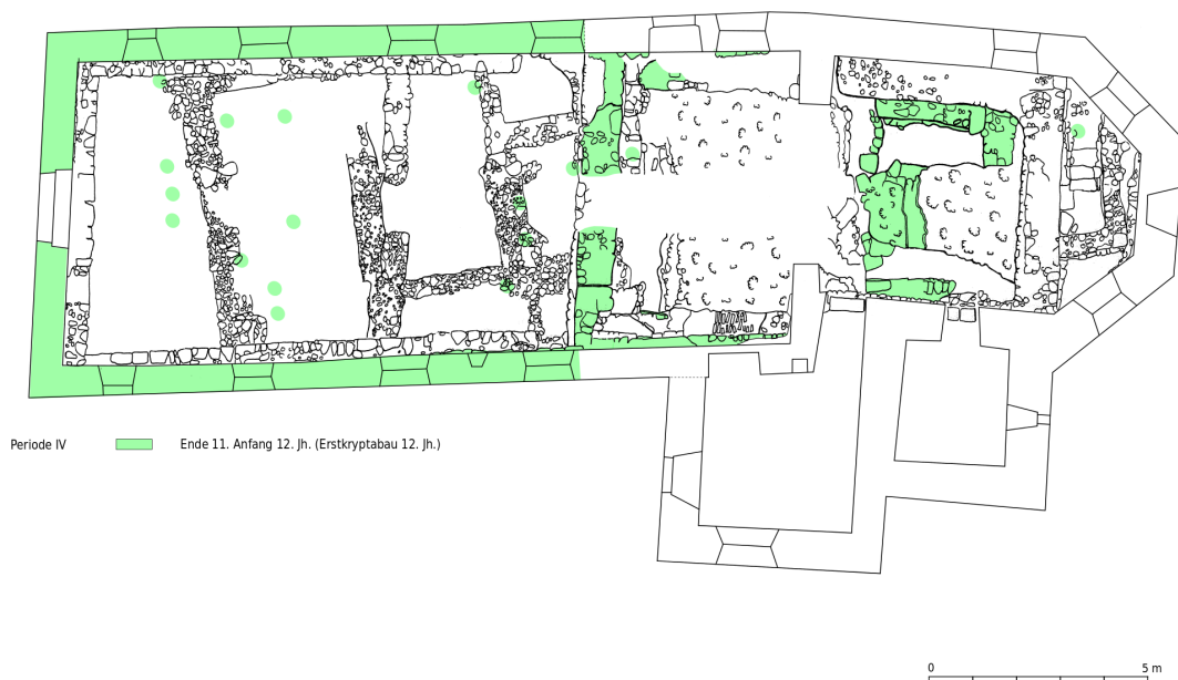
Abb. 42 Fundamentstrukturen des Kirchengebäudes der Periode mit zugehörigen Gerüstpfostengruben
