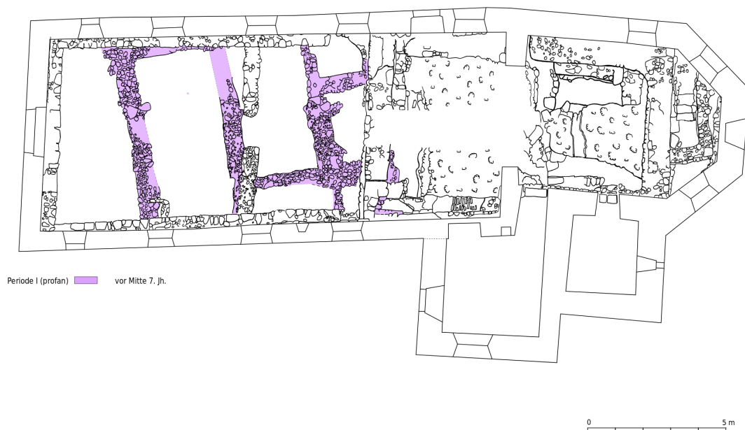
Abb. 29 Erfasste vorkirchliche Mauerreste innerhalb des heutigen Kirchengebäudes, westlicher Teil, schräg zur späteren Ausrichtung des Kirchenbaus.
