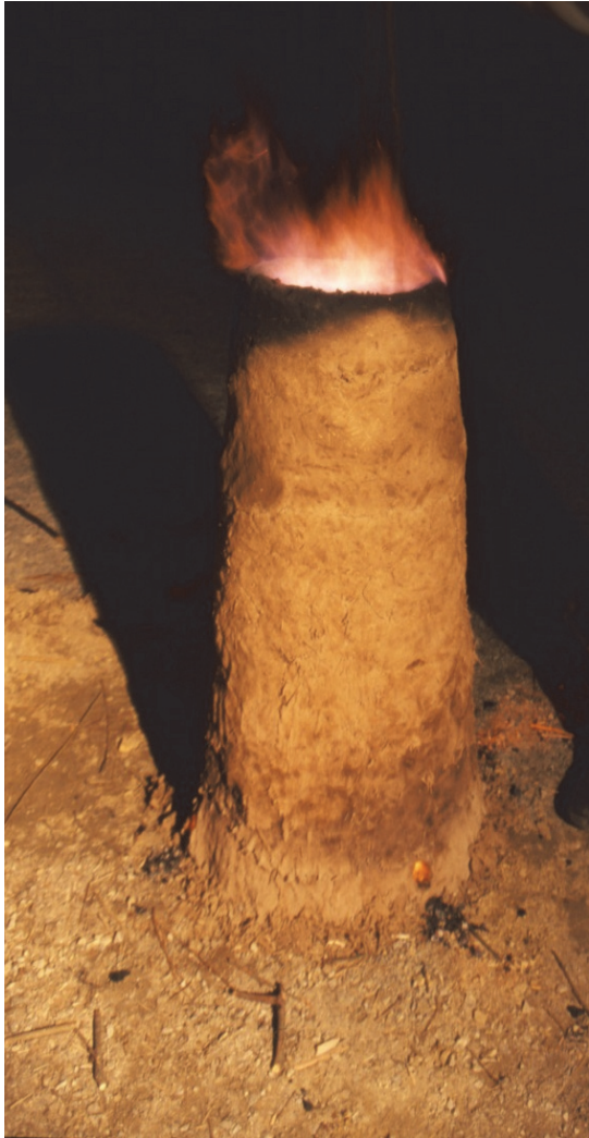
Abbildung 78: Experimentelle Rekonstruktion eines germanischen Rennofens (links). Der Verhüttungsvorgang ist sehr aufwändig und dauert 2 Tage, bis das Roheisen aus dem Erz komplett ausgeschmolzen ist. In einem Abstich wird danach die leichtere Schlacke, die auf dem noch recht unreinen Roheisen schwimmt, aus dem Ofenmund abgelassen, der unterhalb einer Luftdüse liegt (Abb. rechts ganz unten am Ofen). Im Profil eines Rennofen-Befundes bei Klein Görigk ist sehr schön ein typischer Eisenschlacken-Klumpen in situ zu sehen, der sich unterhalb der Eisenluppe an der Ofensohle gebildet hat. Ganz unten befinden sich schwarze Holzkohlereste; vgl. folgende Abb. der schematisierten Prozesse bei der Eisenverhüttung; Abb. Brandenburgisches Landesamt für Denkmalpflege
