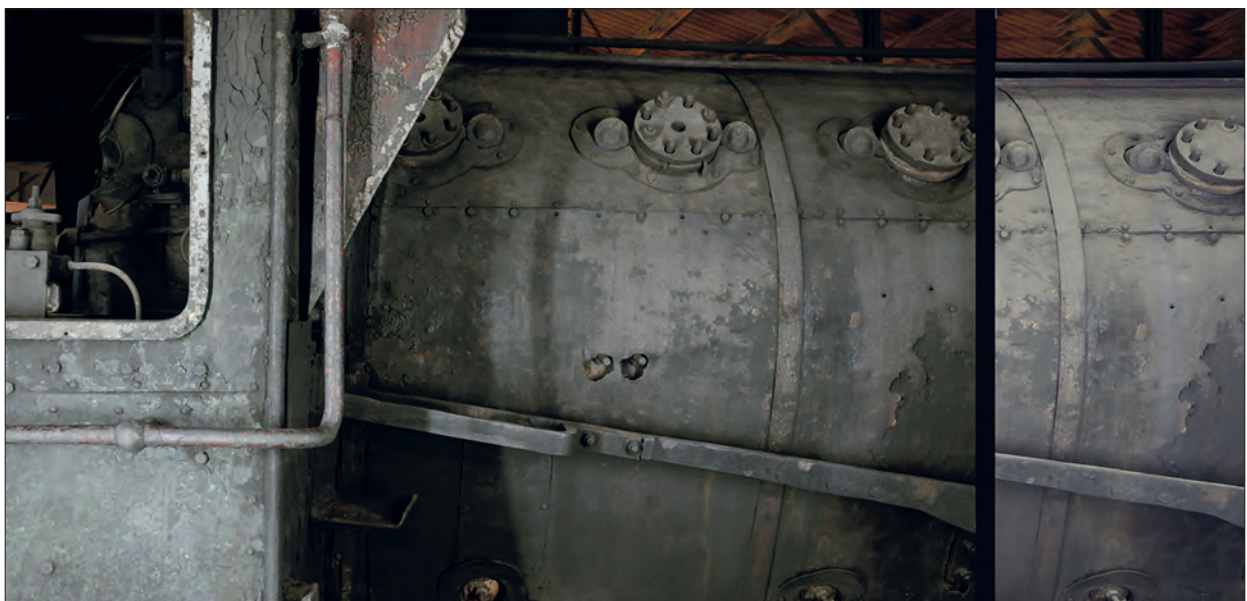
Abb. 1 Lokomotive P8, geprägt von langer Nutzung: Führerstand und von weißlicher Staubschicht überlagerter Kessel vor (rechts) und nach (links) der Reinigung. – (Stiftung Deutsches Technikmuseum Berlin; Fotos G. Hofer, Hochschule für Technik und Wirtschaft Berlin).
