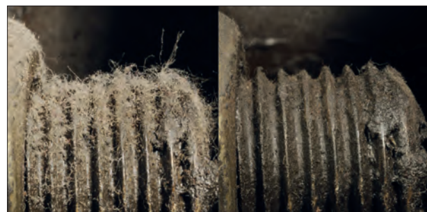
Abb. 4 Schraube vor und nach der Reinigung von am Fett haftendem Staub mittels mehrfach feinst gemahlenen Trockeneisschnee: Gefrorenes CO 2 und die Strahltechnik wurden von Praxair GmbH Berlin projektbezogen zur Verfügung gestellt. – (Stiftung Deutsches Technikmuseum Berlin; Fotos A. Ohde).
