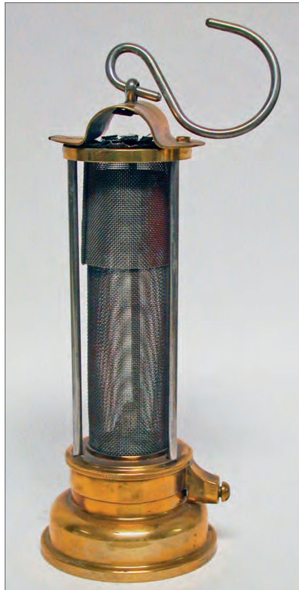
Abb. 6 Replik einer Davy-Lampe aus der Zeit um 1890, hergestellt ca. 1985. Die nach ihren Erfinder Humphry Davy benannte Lampenbauart nutzte als Erste den Effekt eines Drahtgeflechtes als Flammensieb, der die Entzündung von brennbaren Gasen verminderte. Ihr Explosionsschutz war alles andere als perfekt, doch ihre schnelle Verbreitung im 18. Jh. und das für alle weiteren Sicherheitslampen grundlegende Konstruktionsprinzip machten sie zu einer Ikone unter den Grubenlampen. Als beliebtes Souvenir und Andenken wurde sie auch Jahrzehnte später in kleineren Stückzahlen weiter produziert. – (Foto Deutsches Bergbau-Museum Bochum, montan.dok).
