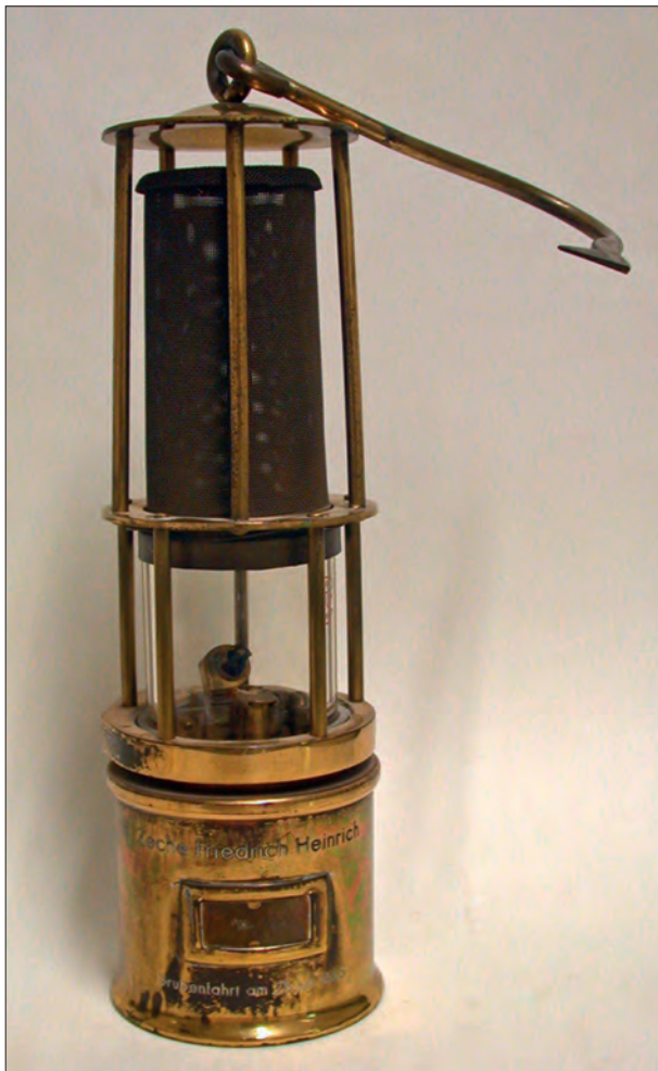
Abb. 4 Benzin-Sicherheitslampe, als Andenken an eine Grubenfahrt auf der Zeche Friedrich-Heinrich am 28. Juli 1965 übergeben an den Vorsitzenden der IG Bergbau und Energie und MdB Walter Arendt. – Lampen diese Bauart sind neben »Schlägel und Eisen« das Symbol für Bergbau, waren zu diesem Zeitpunkt jedoch nur noch von besonders geschultem Personal als Gasmessgerät geführt, während im Arbeitsalltag elektrische Lampen üblich waren. – (Foto Deutsches Bergbau-Museum Bochum, montan.dok).
