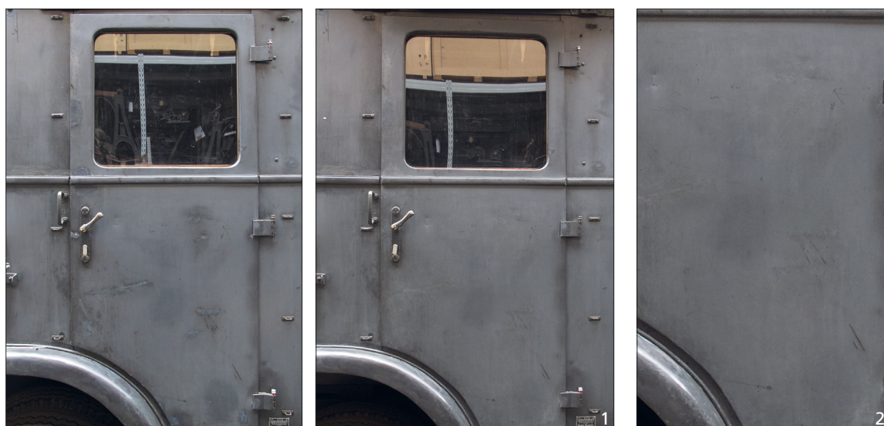
Abb. 8 1 LG 3000, »H3E« Beifahrertür: links vor, rechts nach neuer Bearbeitung und Retusche. Gebrauchsspuren wie mittig verdichtete Fläche von vormals die Tür zuschiebenden Schultern sind wahrnehmbar. Wirkmacht authentischer Oberfläche verlangt Verzicht auf schützenden Wachs und Erneuerung der Retuschen. – 2 Vielschichtig, ruhige Farbfläche umfängt unmittelbar Davorstehende – ähnlich dem Vorgang vor Newmans Farbfeldern. – (Stiftung Deutsches Technikmuseum Berlin; Fotos N. Krautschick, HTW Berlin 2016).
