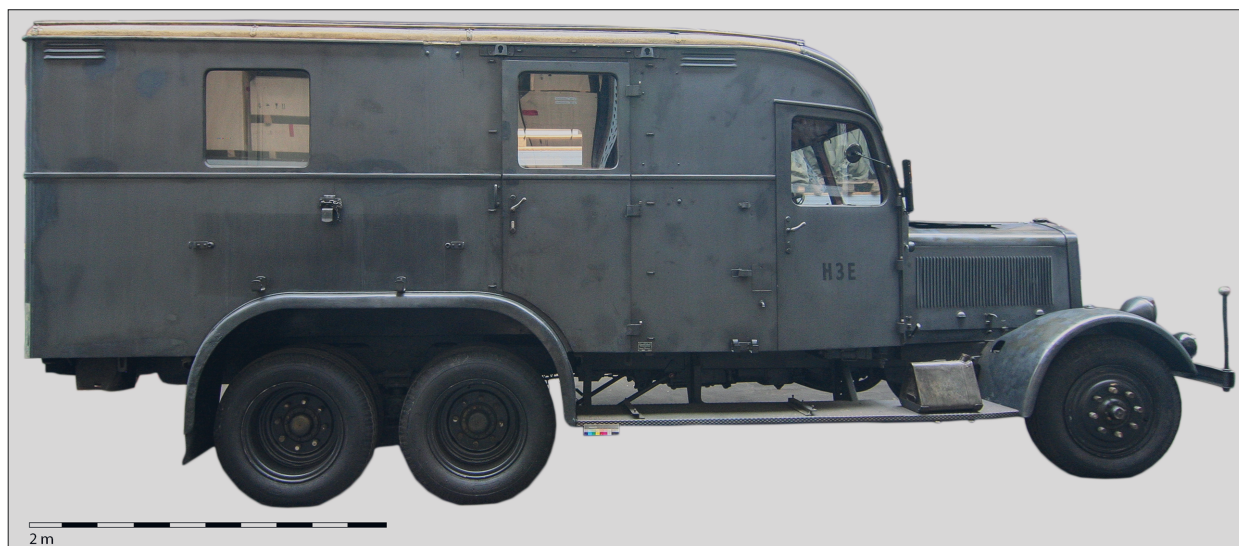
Abb. 7 »H3E«, die Hochfrequenzstufe des Senders »Heinrich«, komplexe elektrotechnische Anlage, eingebaut in einen Lastwagen des Typs LG 3000 als Teil einer Sendeanlage der Deutschen Reichspost aus dem Zweiten Weltkrieg, nachgenutzt für den Aufbau des RIAS in Berlin, dort bis 1980er Jahre, heute Stiftung Deutsches Technikmuseum Berlin. – (Stiftung Deutsches Technikmuseum Berlin; Foto U. Stahn, HTW Berlin).
