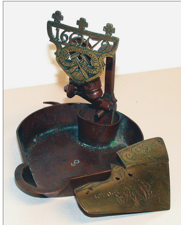
Abb. 5 Eine Froschlampe aus Sachsen von 1679. Als Prunkgeleucht zu Repräsentationszwecken statt für den tatsächlichen Einsatz gedacht, sind die offene Fettschale, der Bügel und der Haken aus Kupfer anstelle des gewöhnlich verwendeten Eisenblechs, Schild und Fettlöffel sind reich verzierte Messingarbeiten. – (Foto Deutsches Bergbau-Museum Bochum, montan.dok).
