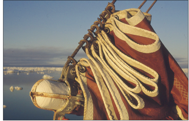
Abb. 8 Ein modernes Kunstfasersegel (ein Klüver), an der Nock des Bugspriets eines Traditionsseglers. An den eingepressten Kauschen, dem Nahtstichbild sowie dem weißen Tuchstreifen an der Vorkante des Segels erkennt man sofort ein modernes Segel. – (Foto J. Bohlmann).
