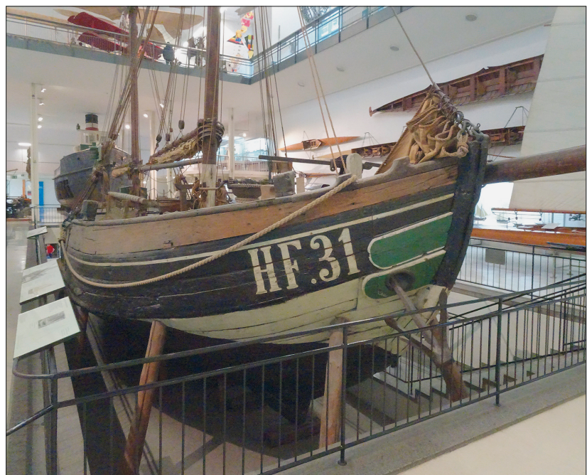
Abb. 1 Fischereiewer »HF 31 Maria« im Deutschen Museum in München. Im Vordergrund sind die abstützenden Pallhölzer gut erkennbar. – (Foto J. Broelmann, München).
