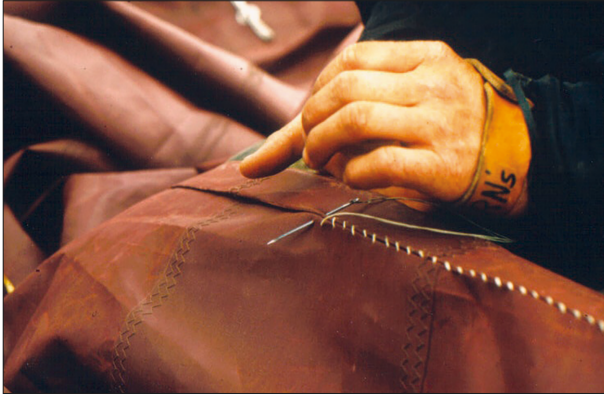
Abb. 7 Die Reparatur eines modernen Kunstfasersegels an Bord eines Traditionsschiffes von Hand; und somit auf traditionelle Art unter Verwendung moderner Materialien. – (Foto J. Bohlmann).
