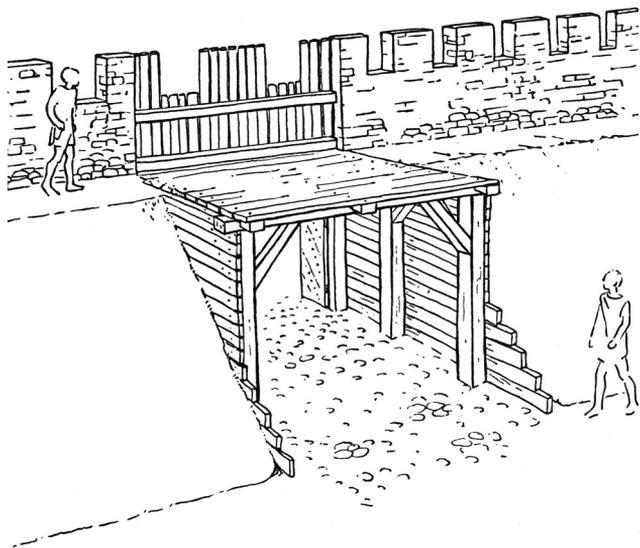
Bei Ausgrabungen im Jahr 1957 wurde das Südtor des Rendelkastells erfasst: Es ist als einfache, Holzverschaltete Bresche im Erdwall konstruiert.
