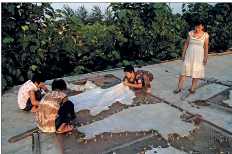
Abb. 74 Lederspanvorrichtung in China. Das Leder wird mit Klemmen auf einem Netz befestigt. – ( http://annierollins.files.wordpress.com/2011/08/leatherstretching.jpg [10.3.2017]).
