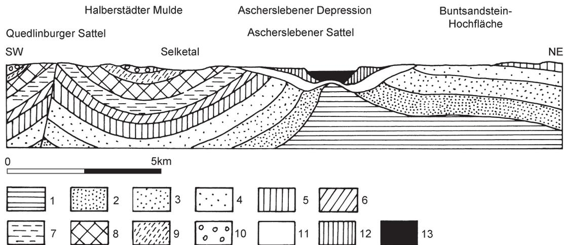
**Abb. 66** Geologischer Querschnitt durch den Ascherslebener Sattel und die Ascherslebener Depression (Mania 1967b): **1** Zechsteinsalinar. – Unterer (**2**), Mittlerer (**3**), Oberer (**4**) Buntsandstein. – Unterer (**5**), Mittlerer (**6**), Oberer (**7**) Muschelkalk. – **8** Keuper. – **9** Jura. – **10** Kreide. – **11** Tertiär. – **12** Alt- und Mittelpleistozän. – **13** Jungpleistozän und Holozän. – Höhe des Ausschnitts: etwa 400 m bis 500 m. – (Illustration D. Mania).
