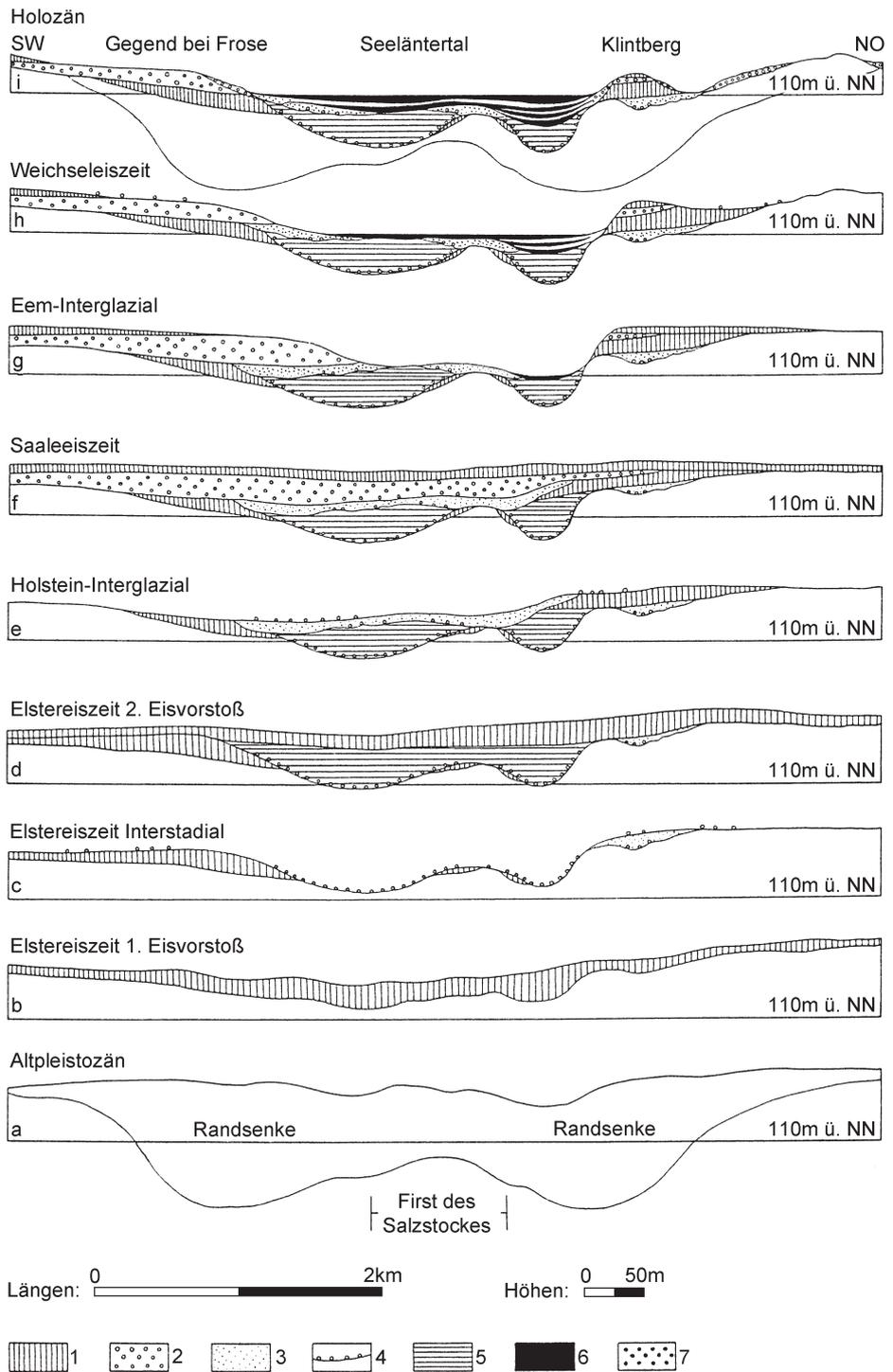
**Abb. 67** Die Entwicklung der Ascherslebener Depression seit dem Altpleistozän, dargestellt an der Veränderung des Querprofils (Mania 1967b).
