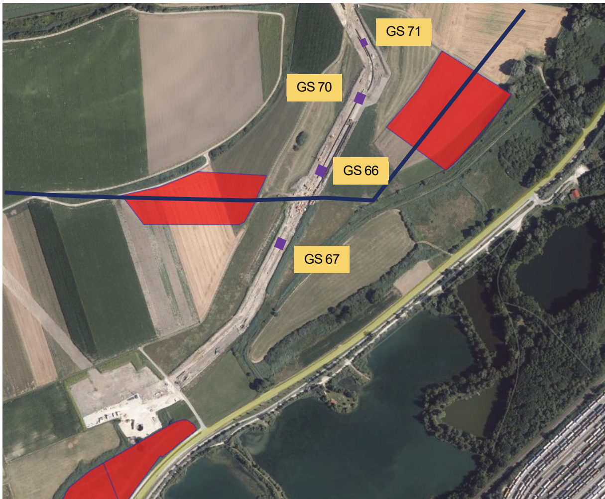
Abb. 8: Verlauf des ersten Abschnitts der TM 26 (Bpl. 15 und 16) von Südwesten (östlich Pressgrube Mauerner Badesee) Richtung Nordosten mit angelegten Geosondagen, eingetragenen Bodendenkmälern im Umfeld der Trasse und der Leitungsquerung der Bayernoil Leitung (blaue Linie) (Quelle: geoportal.bayern.de).
