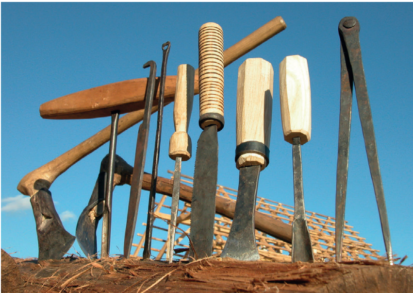
11 Eisenwerkzeuge nach keltischen Vorbildern, die bei den Aufbauarbeiten im Freilichtmuseum in Schwarzenbach zum Einsatz kamen; von links nach rechts: Tüllenbeil, Lappendechsel, Löffelbohrer, Hakengriffmesser, Rindennadel, Pfriem, Stemmbeitel, Schnitzseisen, Zirkel.
