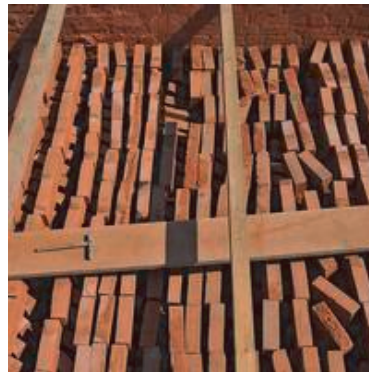
Abbildung 37 Blick von oben in die Ofenkammer (Immenkamp 2011a)
