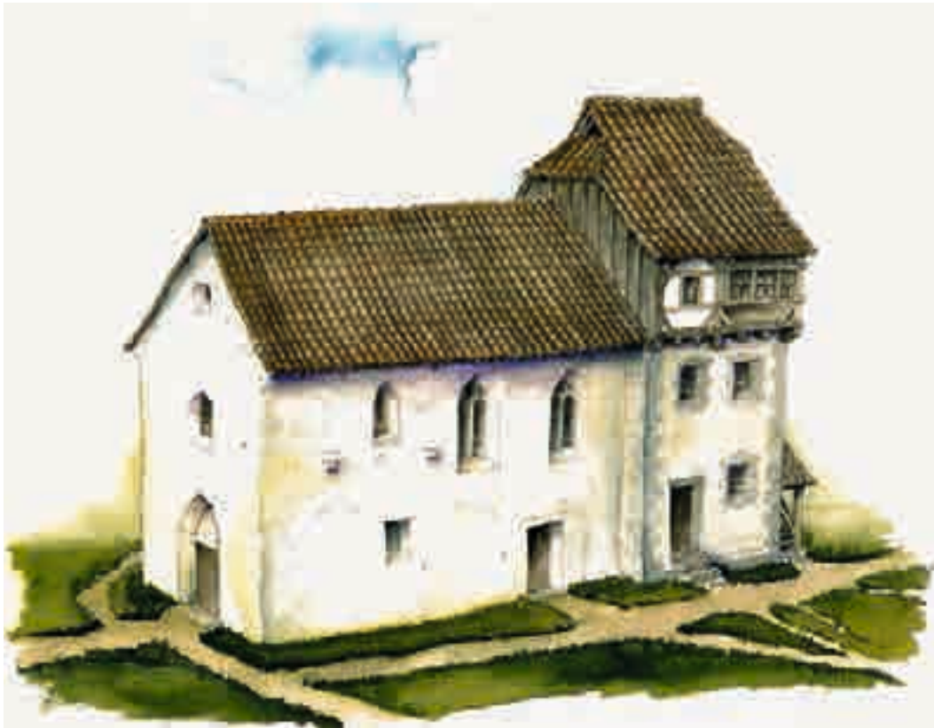
140 Rekonstruktion des zweigeteilten dritten Kirchenbaus mit profaner Nutzung im Westteil und sakraler Nutzung im Ostteil, mit östlich angebautem Wohnturm (Phase IIIb, um 1500).
