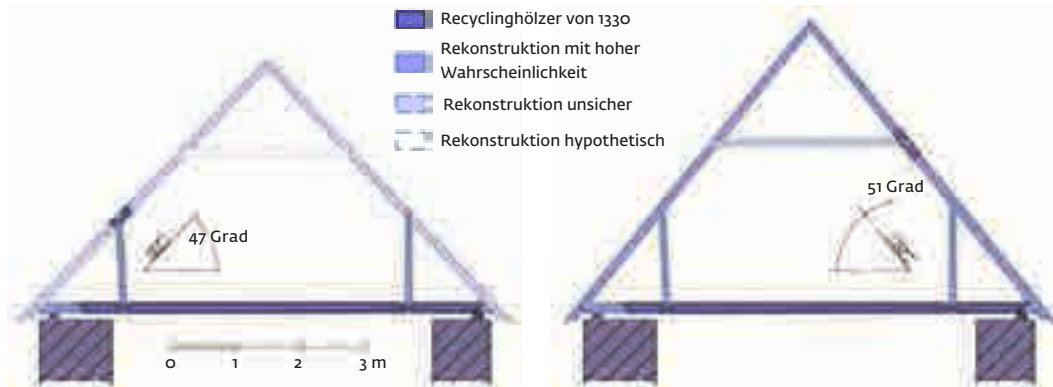
228 'Rekonstruktionsvarianten der Gespärre von 1330 (1330 [d]) je nach Orientierung des Sparrenfragmentes.
