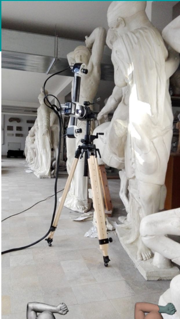
3D-Scanning mit einem Streifenlichtscanner der Abgüsse vor dem Umzug
