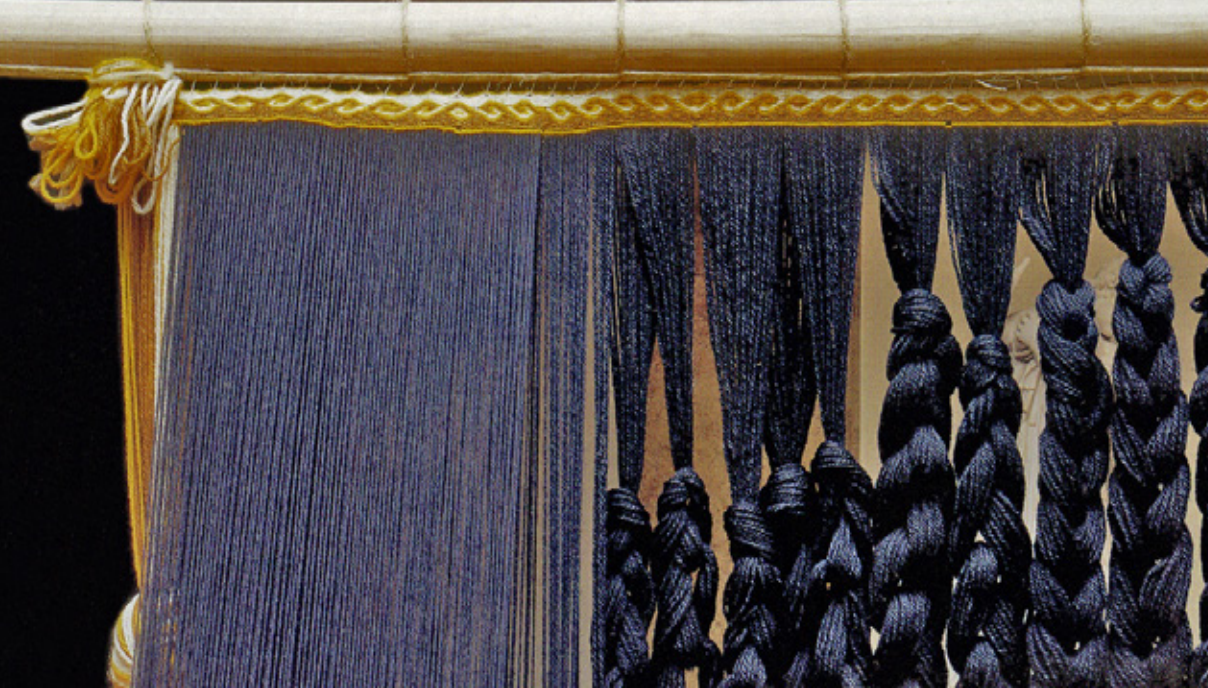
Anfangsband mit laufendem Hund und schwarzen Kettfäden. Links ist die Webkante für das gleiche Muster vorbereitet.
