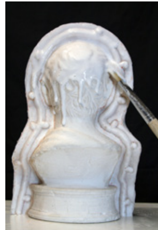
Dünnflüssiges Silikon bildet die erste Schicht, die sog. Zeichenschicht.
