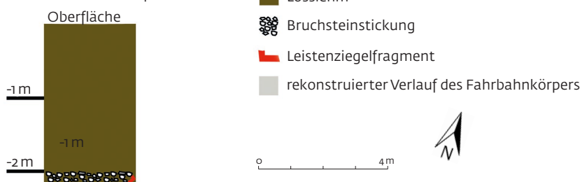
147 Am 2. 10. 1969 durchgeführte Baubeobachtung der Straße Schallstadt-Wolfenweiler (S 20), Umzeichnung der Grabungsdokumentation.
