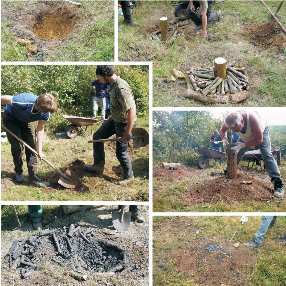
Abb. 3 Meilerexperiment 2009 mit zwei kleinen Grubenmeilern. Oben links: ausgehobene Meilergrube. Oben rechts: Einsetzen von Holz. Mitte links: Abdecken der Charge mit Rasensoden und Erde. Mitte rechts: Ziehen des Rundholzes. Beim Meiler im Hintergrund befindet sich an der Stelle des gezogenen Rundholzes bereits die eingefüllte glühende Holzkohle. Unten rechts: Einstechen von Zugöffnungen. Unten links: geöffneter Meiler mit Holzkohlefüllung.
