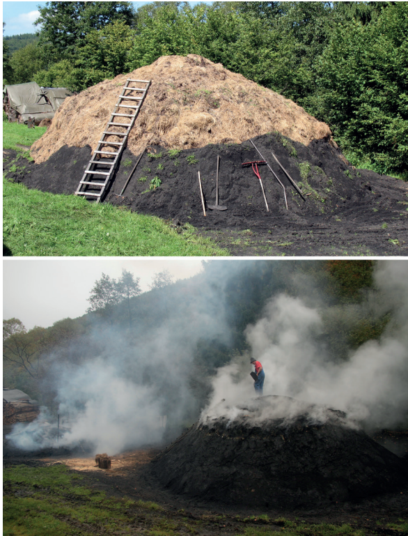
Abb. 1 Köhlerei Reinhold Wagner in Walpersdorf: Meiler im Zustand der Abdeckung (oben) und zwei Meiler während des Meilerbrandes (unten). Der hintere Meiler brennt schon länger und ist eingesackt.
