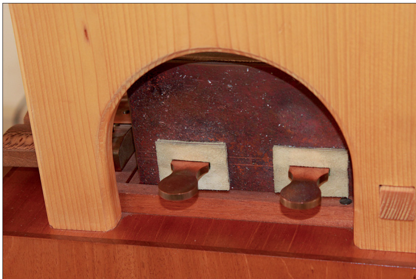
Abb. 4 Rekonstruierte Registerschaltung der Doppelorgel. – (Foto A. Minack, Schwerin).
