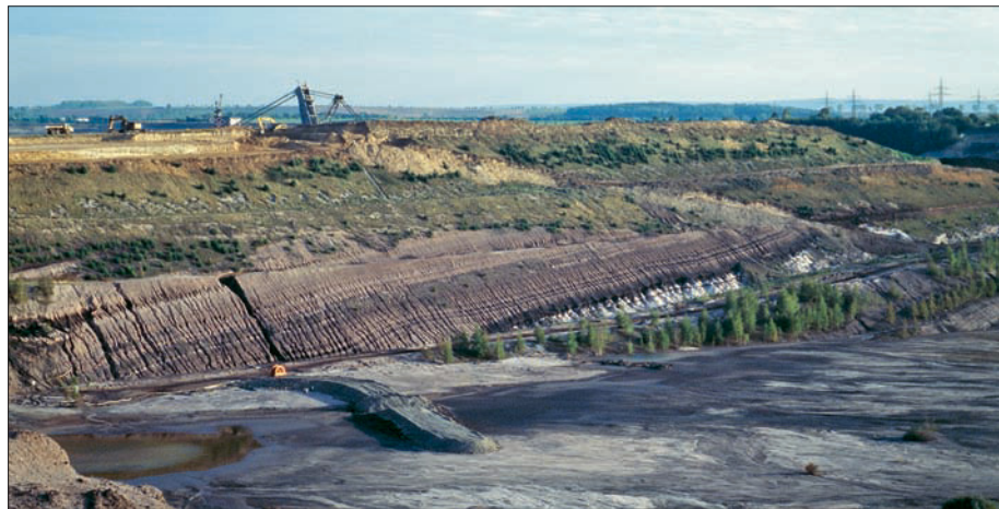
Abb. 10 Tagebau Schöningen, Nordfeld Südwand (= Nordwand Bahnpfleiler) am 23. 9. 2009. – Mit ca. 10° Ost einfallendes Tertiär (Eozän): weißer Sand, Kohle, braune Sande mit humosem Schluff. Die ganze Schichtenfolge zeigt unter dem Holstein-Interglazial (rechts vom Bagger) keinerlei Einmuldung. – (Foto K.-D. Meyer).
