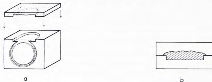
Fig. 1 Coupes des moules de la bague de Malia: a) Moule de l'anneau et du support due chaton. b) Moule du chaton: droit portant la gravure et cheville pour l'encastrement.
