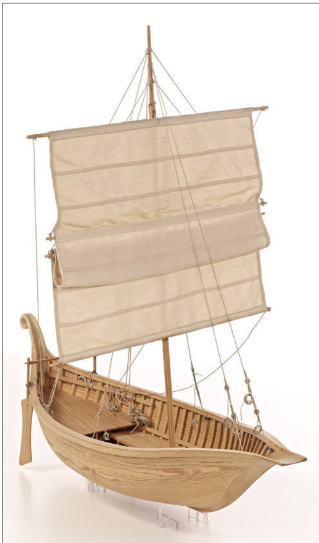
Abb. 4 Modell eines Frachtbootes mit gallorömischem Binnenrigg auf der Grundlage des Mosaikbildes in Bad Kreuznach (vgl. Abb. 3 ). Segel mit einem Reff. – (Design R. Bockius; Fotos V. Iserhardt / R. Müller, RGZM).
