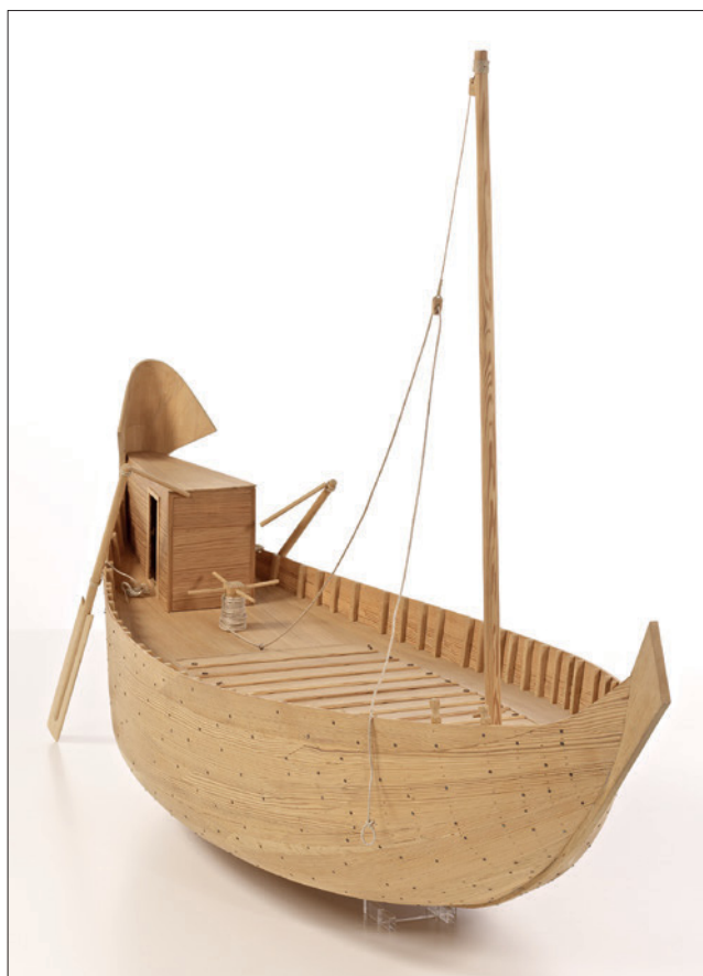
Abb. 9 Modellrekonstruktion eines römischen Leichters Variante 2 im Museum für Antike Schifffahrt in Mainz, generiert auf der Grundlage des Linien des Wracks Fiumicino 1 und eines Grabfreskos aus Ostia antica (vgl. Abb. 7). – (Design R. Bockius; Fotos V. Iserhardt / R. Müller, RGZM).
