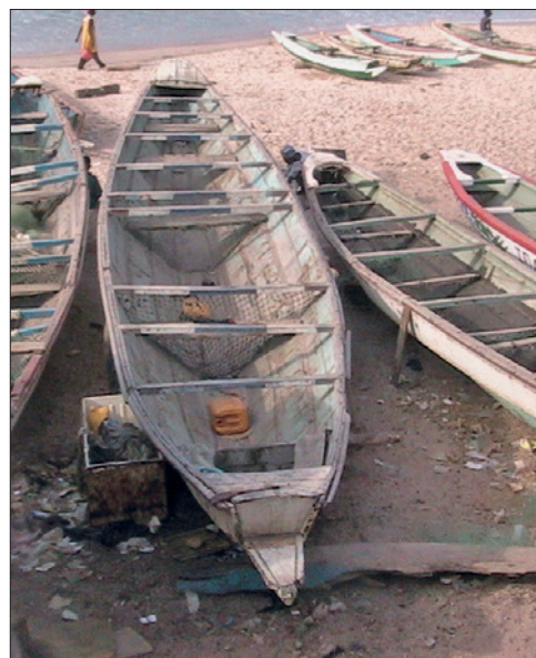
Abb. 15 Pirogen am Strand von Bakau, Gambia. Die spantenlosen Boote ruhen auf einem starken ausgehöhlten Kielholz. Bei größeren Booten ist der Kiel dreigeteilt und steht an beiden Enden über. Die Duchten spreizen den Rumpf und verleihen der Bootsschale eine Vorspannung, die Bewegungen zwischen den Planken im Seegang vermindert. – (Foto Th. Guttandin).
