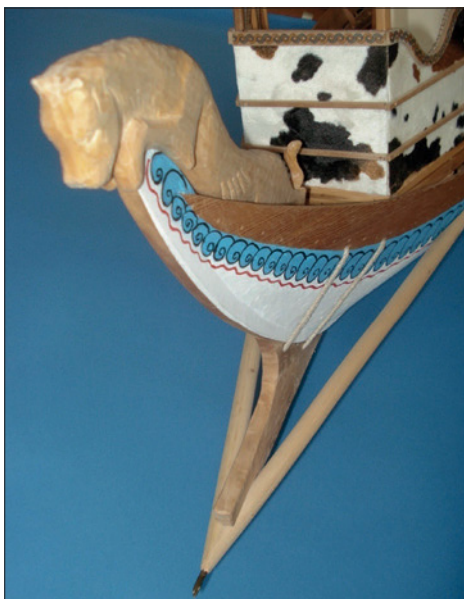
Abb. 24 Modellrekonstruktion eines Thera-Schiffs mit ikrion und Sporn. Die seitlichen Streben des Sporns vermindern die Gefahr des Abknickens. Die Konstruktion aus einem Knieholz und die kraftschlüssige Verbindung sind auf eine Belastung in Längsrichtung ausgelegt, bei der auftretende Kräfte in den Kiel geleitet werden. – (Foto Th. Guttandin).
