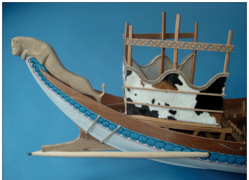
Abb. 24 Modellrekonstruktion eines Thera-Schiffs mit ikrion und Sporn. Die seitlichen Streben des Sporns vermindern die Gefahr des Abknickens. Die Konstruktion aus einem Knieholz und die kraftschlüssige Verbindung sind auf eine Belastung in Längsrichtung ausgelegt, bei der auftretende Kräfte in den Kiel geleitet werden. – (Foto Th. Guttandin).
