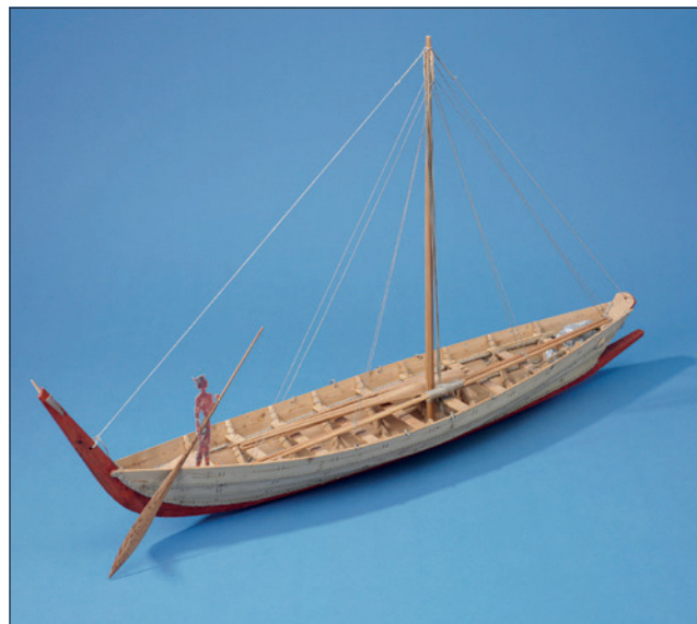
Abb. 17 Modellrekonstruktion nach Siegel Wedde Nr. 705 mit geradem, einteiligem Kiel. – (Modell Th. Guttandin; Foto H. Vögele).
