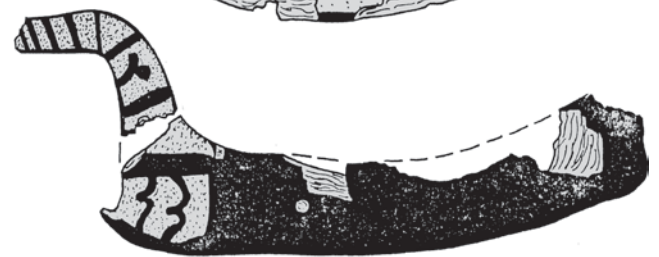
Abb. 12 Die Umzeichnungen der mykenischen Modelle von Asine (oben) und Tiryns (unten). Die breiten, in Längsrichtung der Rümpfe aufgetragenen Linien deuten die Dichtpackungen aus Pflanzenfasern bei gelaschten oder genähten Rümpfen an. Sie wurden meist auf den konkaven Seiten einer Wölbung eingebracht und sind daher auch außen sichtbar. – (Oben: Zeichnung W. Werner in: Göttlicher, Schiffsmodele Taf. 25, 332; unten: Wedde, Hermeneutics Kat.-Nr. 315).
