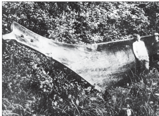
Abb. 7 Bug eines Nootkan-Kanus an der Westküste von Vancouver. Der hohe Bug des Schiffs mit der Wolfsschnauze wurde durch Aufsetzen eines zusätzlichen Bauteils erreicht. Deutlich sind die konkaven Flächen des Bugs zu sehen, die auftreffende Wellen seitlich ableiten. – (Foto Royal BC Museum, BC Archives, Bild AA-00286).
