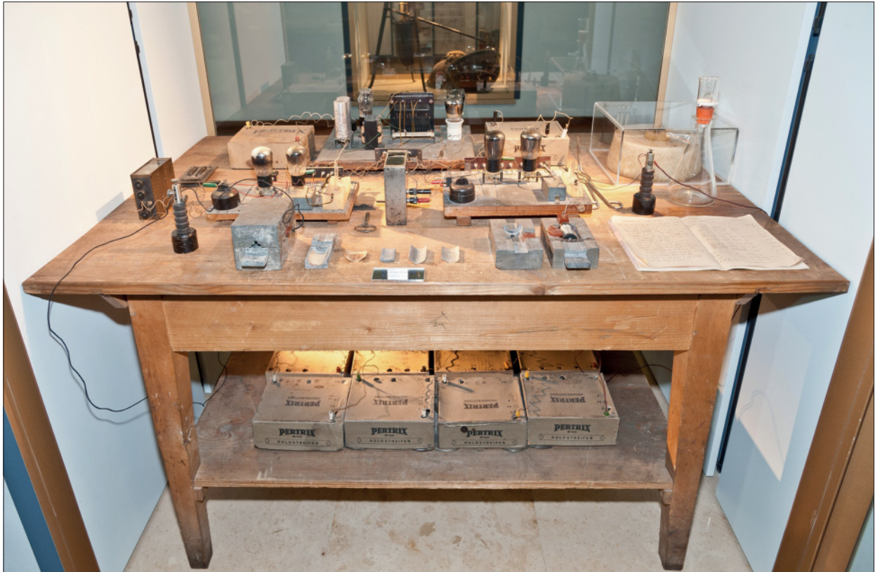
Abb. 1 Der früher so genannte »Otto-Hahn-Tisch« ist eines der bekanntesten Objekte des Deutschen Museums. Es handelt sich um ein Arrangement verschiedener Geräte, mit denen 1938 zum ersten Mal nachweislich eine Spaltung von Atomkernen durchgeführt wurde.
