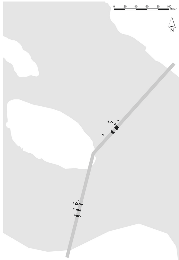
Abb. 3 Der Verlauf der römischen Brücken über den Rhein von Eschenz (Süden) über die Insel Werd nach Arach (Norden). Die Brückenpfeiler (Punktsignatur) stammen von mehreren Bauphasen.
