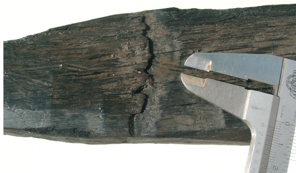
Abb. 7a Eichenpfosten mit deutlich sichtbarer Schartenspur auf den Schlagflächen (Fundnummer: LR 31-V255).
