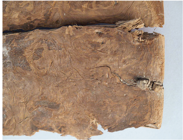
Abb. 6 Maserartige Struktur einer Kübelwand. Erkennbar ist die dreidimensionale Wachstum der Holzzellen.
