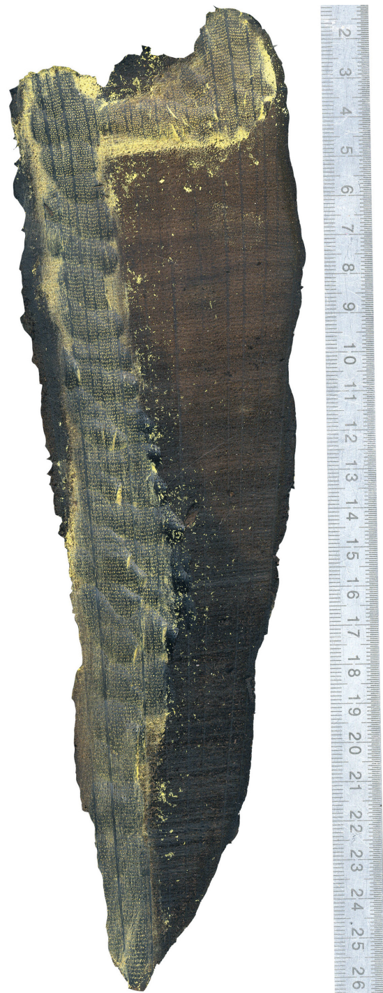
Abb. 8 Querschnitt eines radial gespaltenen Holzes. Hell eingefärbt ist die dendrochronologische Messstrecke. Die Bohle besitzt 286 Jahresringe.
