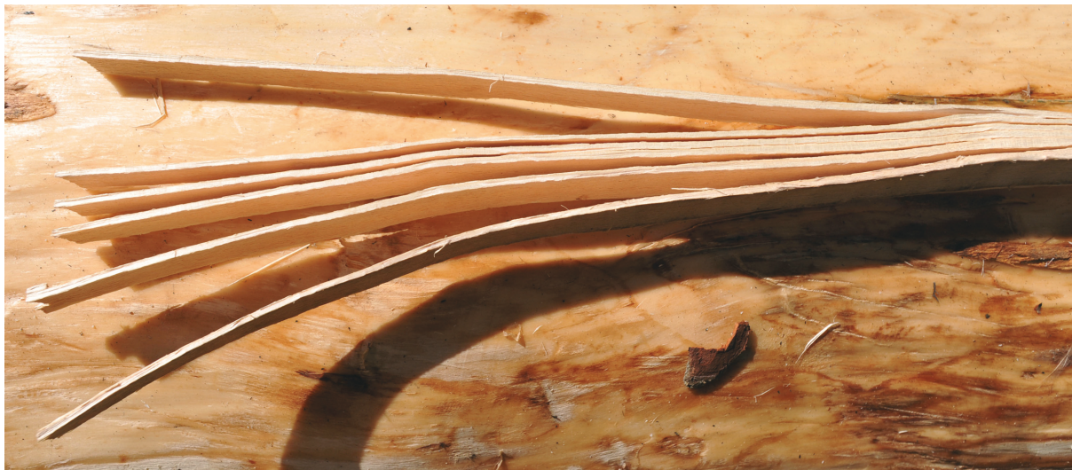
Abb. 10 Durch das Klopfen des Eschenholzes können einzelne Jahrringe (Spätholzbänder) gewonnen werden.
