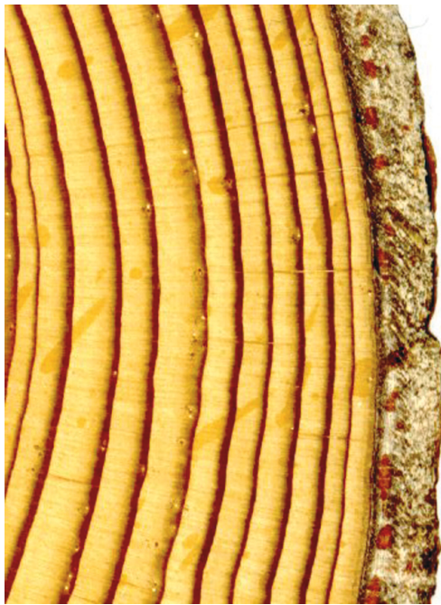
Abb. 5 Querschnitt eines Baumes mit dem äußersten Jahrring, an den die Rinde anschließt. Dies entspricht der Waldkante.
