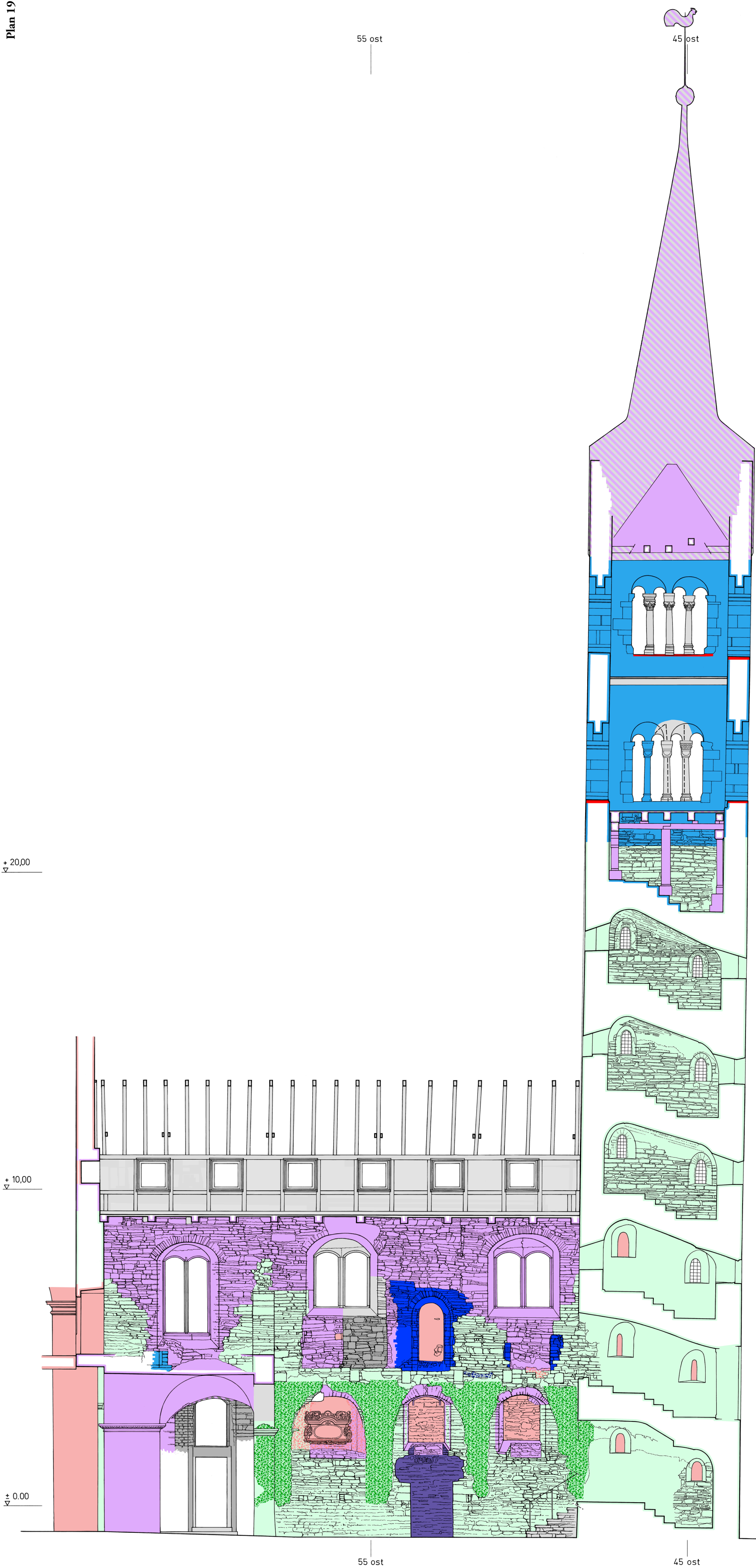
Plan 19 Corvey, Westbau. Längsschnitt durch das Südseitenschiff, Blick nach Süden. Bestand 2011 mit Eintragung der Bauphasen und von Befunden der Untersuchungen zwischen 1950 und 2010 und Zählung der Stufen im Südturm. Maßstab 1 : 100
