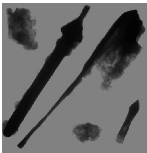
1 Röntgenaufnahme Glasmacherwerkzeuge und Armbrustbolzen 70kV_2mA_0,01 s.
