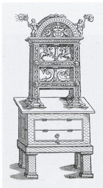
Abb. 266 Zweigliedriger Ofen (Gusseisen?), über einem quaderförmigen Feuerungskasten ein durch einzelne Züge gegliederter Oberofen. Hierdurch sollten die Heizgase an ihrem ungebremsten Austritt in den Schornstein gehindert und dadurch die Abstrahlungswärme des Ofens deutlich erhöht werden, 1564.
