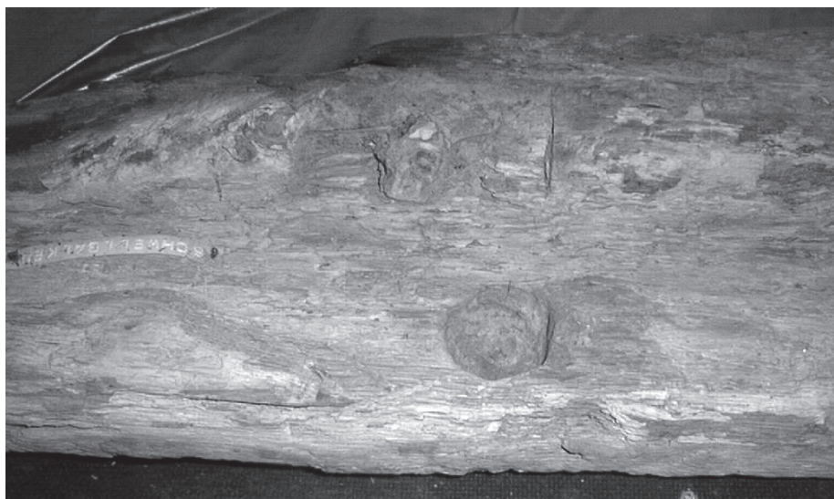
Abb. 8.14 Schwellbalken einer Fachwerkkonstruktion. Bruchstück B. Auslinkung mit Eisennagel (vgl. Abb. 8.12g).
