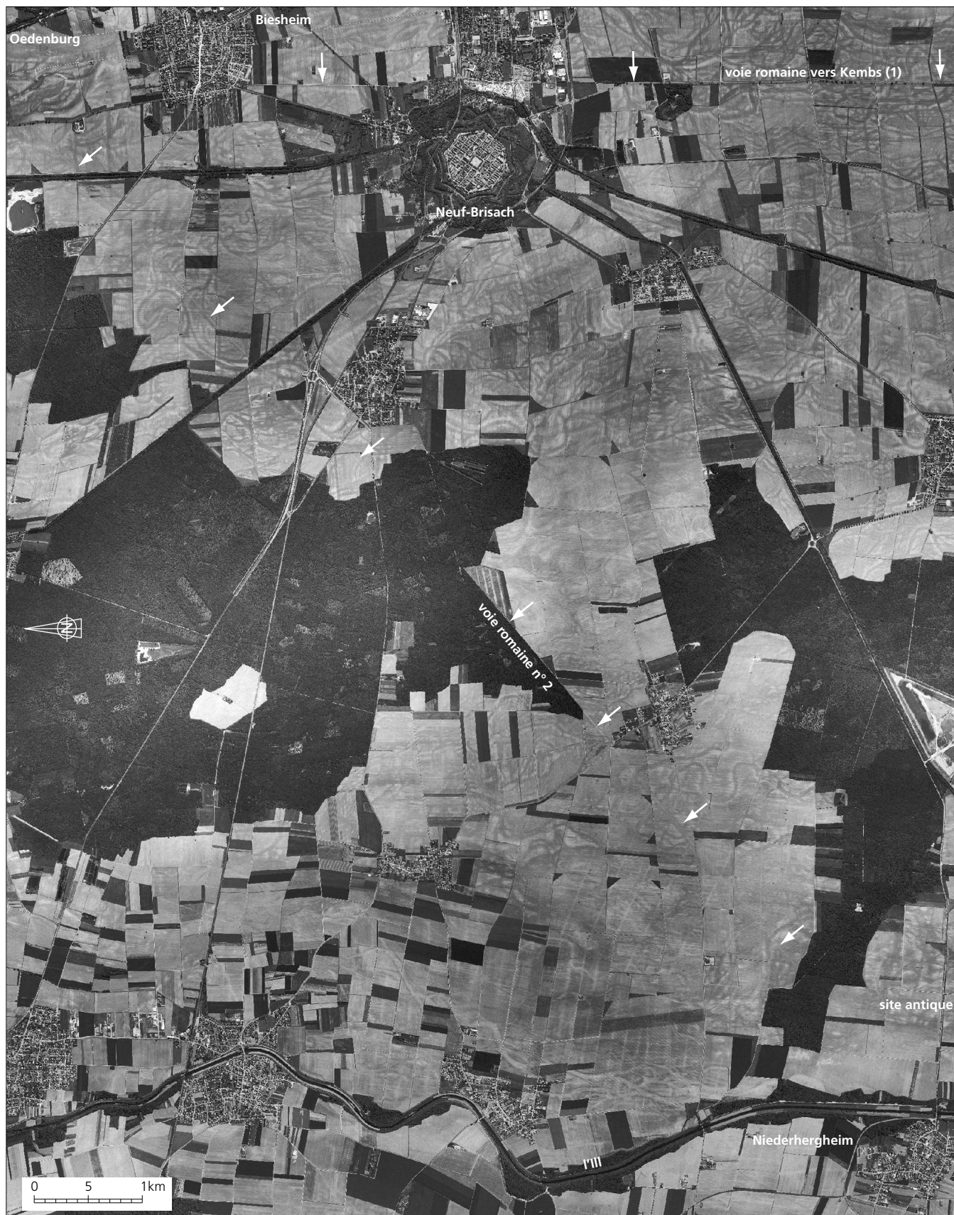
Fig. 12.3 Photographie aérienne orthorectifiée montrant la voie n° 2 (voir fig. 12.1) entre Oedenburg et Niederhergheim (photo IGN). Le nord est à gauche.
